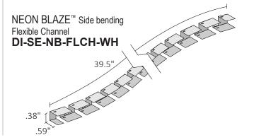
SIDE BENDING STRIP LIGHT SPECIFICATION SHEET
